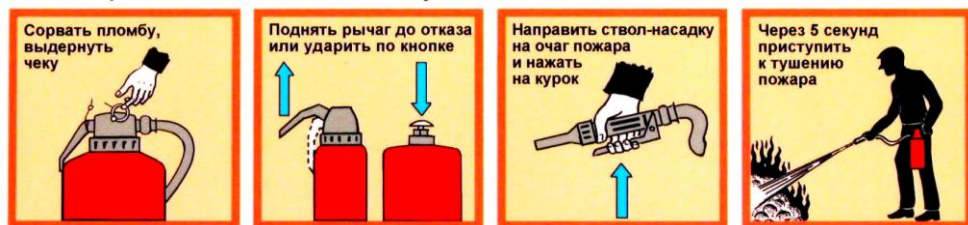
Рисунок 4.2 – Принцип действия огнетушителя со встроенным источником давления
