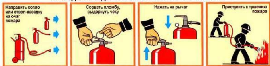
Рисунок 4.1 – Принцип действия закачного порошкового огнетушителя
