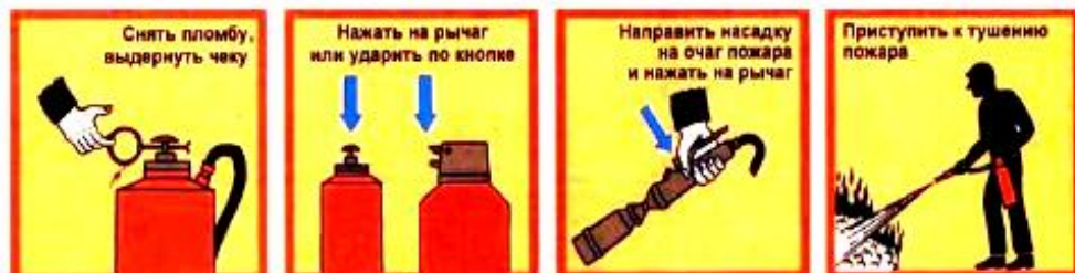
Рисунок 4.6 – Принцип действия воздушно-пенного огнетушителя типа ОВП
