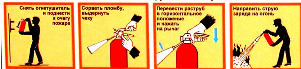
Рисунок 4.8 – Принцип действия углекислотного огнетушителя ручного типа
