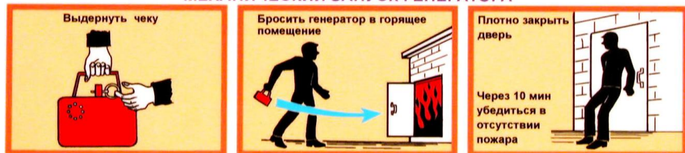
Рисунок 4.19 – Принцип действия аэрозольных генераторов ручного действия
