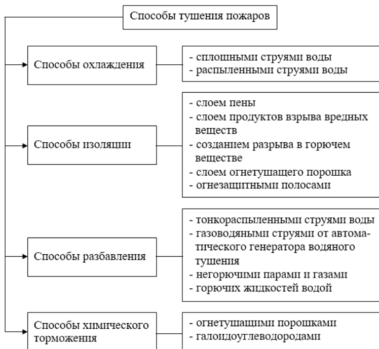
Рисунок 3.1 – Способы тушения пожаров
