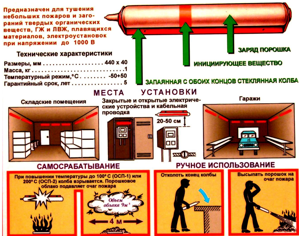
Рисунок 4.17 – Принцип действия самосрабатывающего огнетушителя
