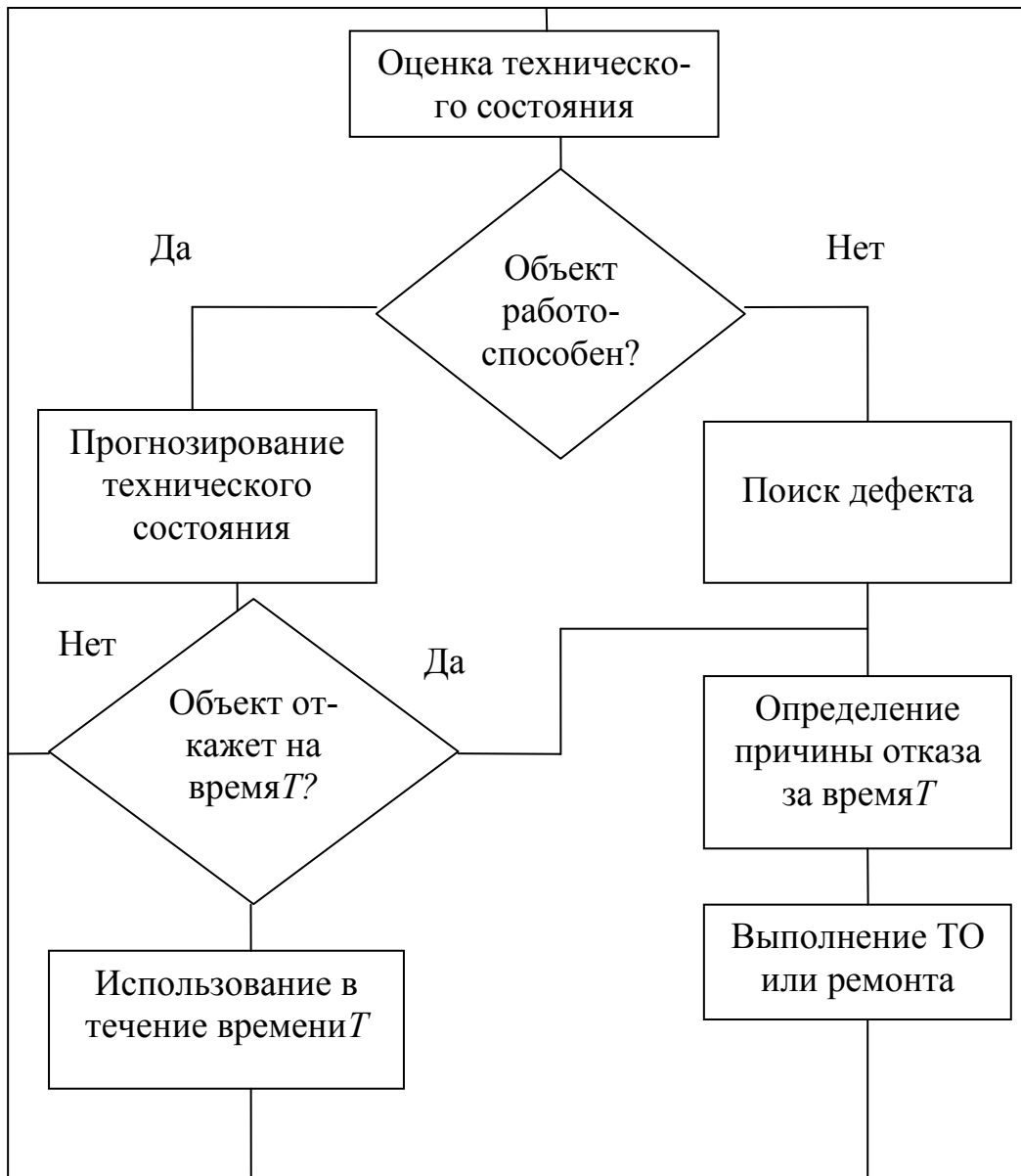
Рисунок 2.4 – Алгоритм принятия решения о необходимости ТО, времени его проведения и объеме, а также о времени проведения очередного контроля технического состояния
