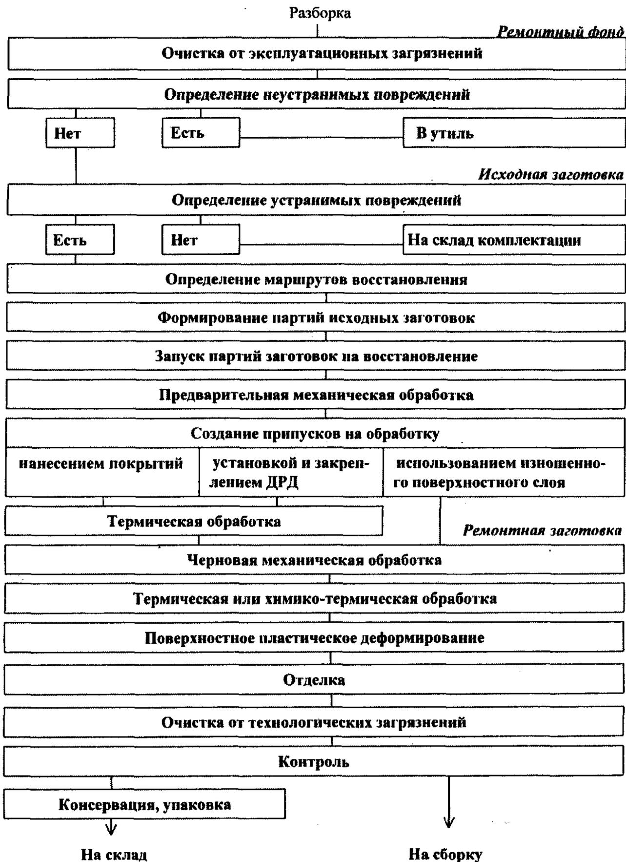
Рис. 3.1. Схема технологического процесса восстановления детали
