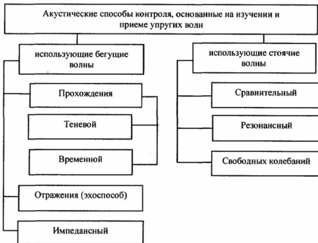
Рис. 4.4. Классификация акустических способов контроля
