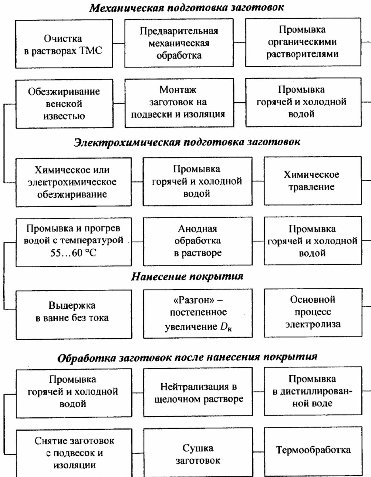
Рис. 5.13. Типовой процесс нанесения гальванических покрытий
