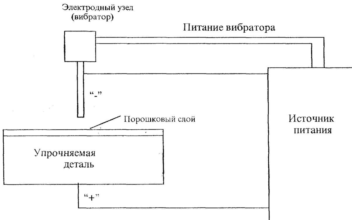
Рис. 5.16. Технологическая схема процесса ЭЭСП
