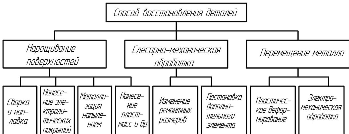
Рис. 2.1. Классификация способов восстановления деталей
