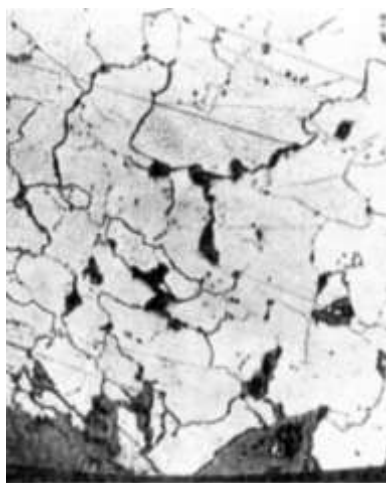
Рис. 4.59. Микроструктура в зоне повреждения, \times 500
