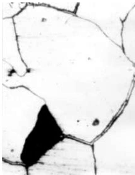
Рис. 4.55. Двойные границы зерен и полость. Растрескивание по границам зерен, \times 500
