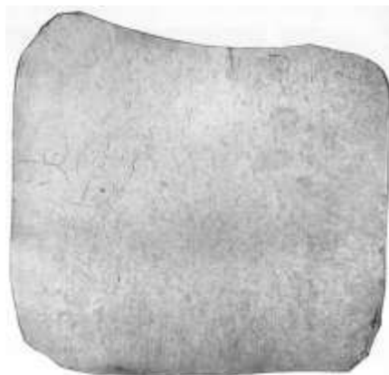
Рис. 2.27. Макроструктура заготовки стали 12X17 с сеткой шлифовочных трещин
