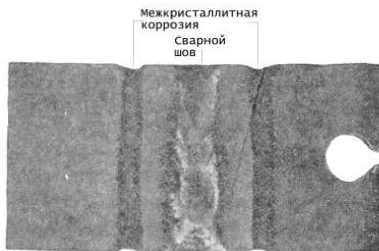
Рис. 3.3. Межкристаллитная коррозия в зоне сварного шва ( \times 2 ). Образец после сенсibilизации выдержан в 25% растворе \text{HNO}_3
