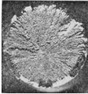
Рис. 5.26. Излом гладкого образца из высокоуглеродистой стали после испытания на растяжение при -196^{\circ}\text{C} . Состоит из радиальной зоны и зоны среза. Структура стали – отпускаемый мартенсит, твердость HRC 35. Волокнистая зона отсутствует. Радиальные рубцы занимают почти всю площадь излома, за исключением узкой зоны среза. \times 12
