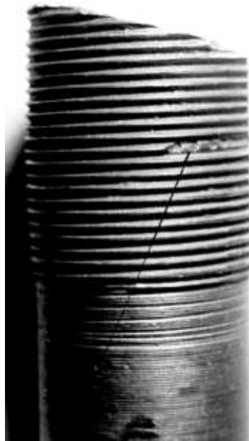
Рис. 4.80. Расположение излома по отношению к оси штока
