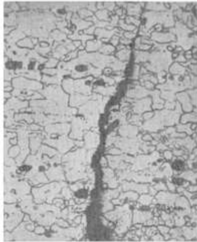
Рис. 3.7. Коррозионно-усталостная трещина на листе малоуглеродистой стали, возникшая при вибрации листа в конденсате дымовых газов
