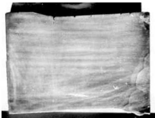
Рис. 4.69. Усталостные трещины на внутренней поверхности в районе расточки под подкладное кольцо
