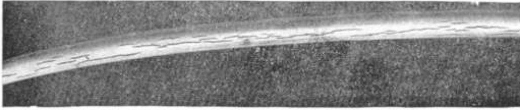
Рис. 2.37. Трещины напряжения в прутке диаметром 6,5 мм калиброванно-го дисперсионно-твердеющего сплава НИМО-25 после медленного нагрева до кристаллизации. \times 0,9
