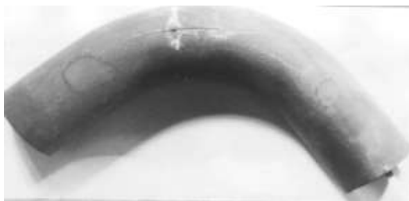
Рис. 4.47. Трещина на наружной поверхностигиба
