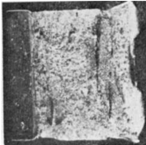
Рис. 5.39. Поперечные вторичные трещины в изломе ударного образца Шарпи (ASTM A514, тип F) конструкционной стали с временным сопротивлением 760 МПа. Работа разрушения при 27°C составляла 102 Дж. \times 5
