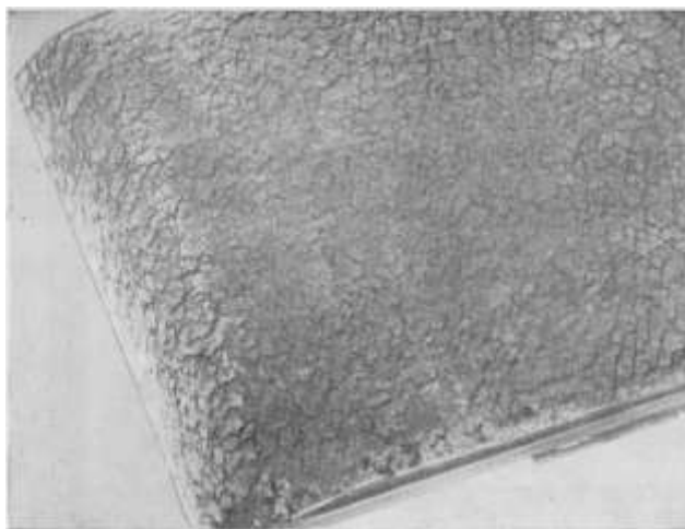
Рис. 2.42. Внешний вид заготовки с чешучатостью (ГОСТ 20847-75)
