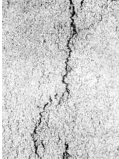
Рис. 4.32. Межзеренный характер трещины в зоне термического влияния, \times 100
