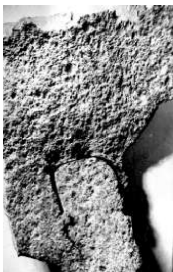
Рис. 4.76. Характер коррозии на внутренней поверхности осколков баллона и расположение трещин
