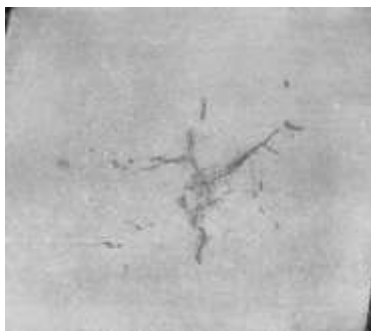
Рис. 2.21. Внутренние ковочные трещины в заготовке стали X35H50BM (ЭП648). Микршлиф с трещинами, разветвленными по направлениям ковочного креста
