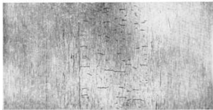
Рис. 2.25. Флокены в продольном макрошлифе стали 18Х2Н4ВА
