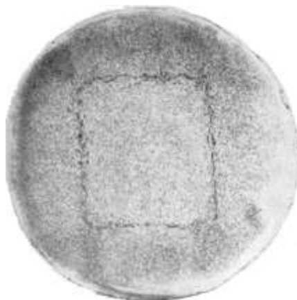
Рис. 2.12. Ликвационный квадрат в макроструктуре прутка конструкционной стали
