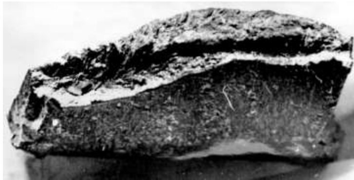
Рис. 4.78. Закат в сечении излома
