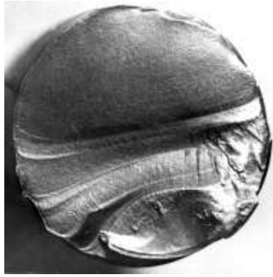
Рис. 4.79. Строение излома штока, \times 2,3
