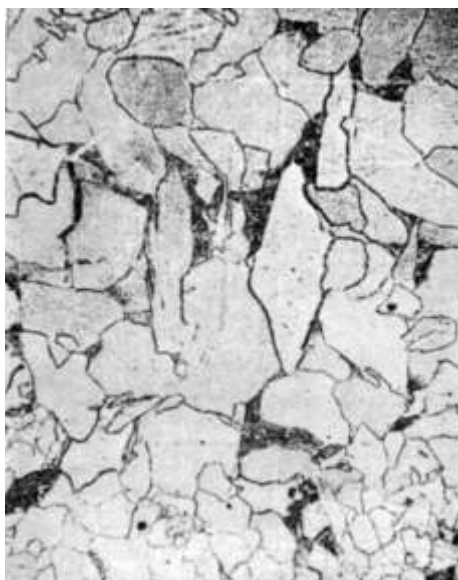
Рис. 4.27. Структура металла шва после перегрева выше температуры A_{c3} при отпуске, \times 100
