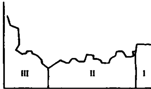
Рис. 3.17. Схема роста трещины при высокотемпературной малоцикловой усталости
