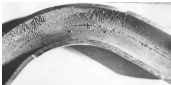
Рис. 4.48. Характер развития трещин на внутренней поверхностигиба и отложения грата
