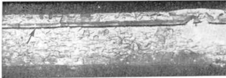
Рис. 2.51. Внешний вид прутка с подрезом (ГОСТ 20847-75)
