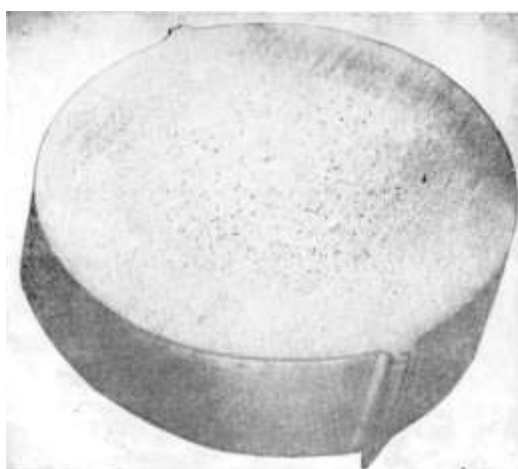
Рис. 2.44. Внешний вид и макроструктура прутка с усом
