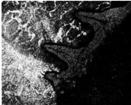
Рис. 4.39. Усталостные трещины в металле шва и околошовной зоне углового сварного соединения, \times 100
