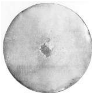
Рис. 2.22. Внутренние разрывы, образовавшиеся при ковке (обкатке) в плоских бойках прутков диаметром 340 мм из стали 37X12H8МФБ (ЭИ481). Образованию разрывов способствовало присутствие в осевой зоне скопленных карбидов в связи с дендритной ликвацией
