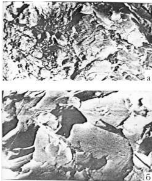
Рис. 6.16. Виды разрушения стали 12X1МФ: смешанный характер разрушения ( \sigma = 160\text{МПа} ), \times 1000
