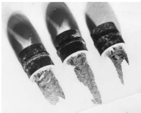
Рис. 4.62. Дросселирование сечения труб сварочным гратом
