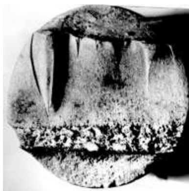
Рис. 4.81. Строение излома. Микроструктура стали рядом с изломом
