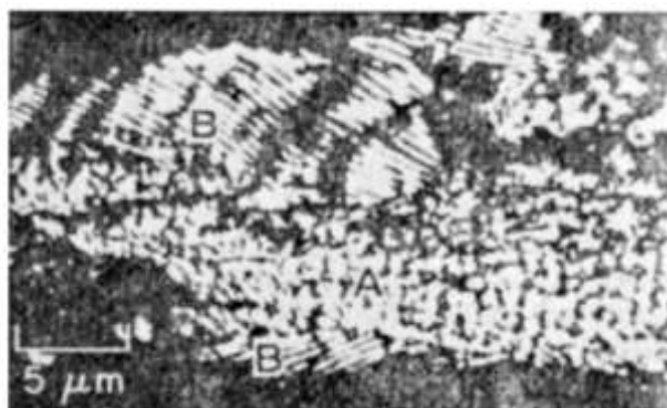
Рис. 5.36. «Храповый» узор в изломе плоского образца из алюминиевого сплава 7075-Т6. Образование ступенек свидетельствует о том, что усталостные трещины возникли в нескольких центрах и затем соединились, образуя один фронт магистральной трещины. \times 7(1/2)
