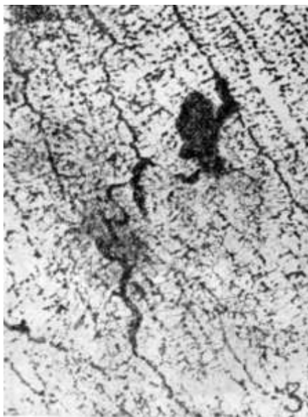
Рис. 4.30. Кристаллизационная трещина в шве на фоне структуры затвердевания, \times 100
