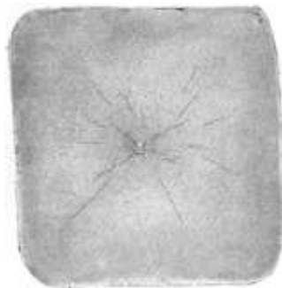
Рис. 2.24. Флокены в заготовке 140×140 мм из стали 37ХН3А, охлажденной после прокатки на воздухе
