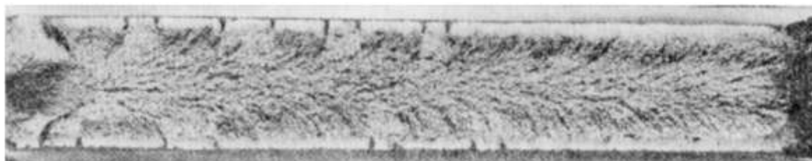
Рис. 5.28. Шевронный узор на поверхности разрушения плоского стального образца, происшедшего с высокой скоростью. Очаг разрушения расположен на левом конце образца и граничит с небольшой волокнистой зоной. Остальная поверхность излома – шевронные узоры, или «елочка». Вершины V-образных шевронов направлены от очага разрушения
