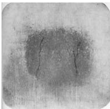
Рис. 2.19. Грубые внутренние разрывы, возникшие при деформации вследствие осевого перегрева стали 37X12H8Г8МФБ, \times 0,7
