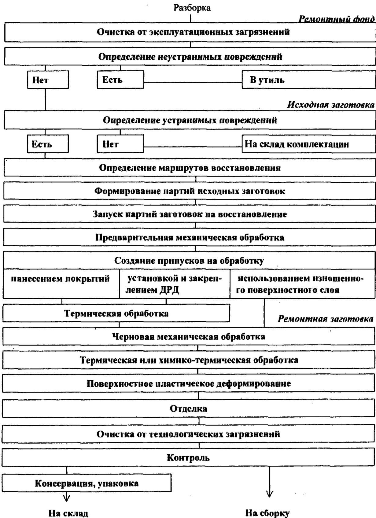
Рис. 11. Схема технологического процесса восстановления детали
