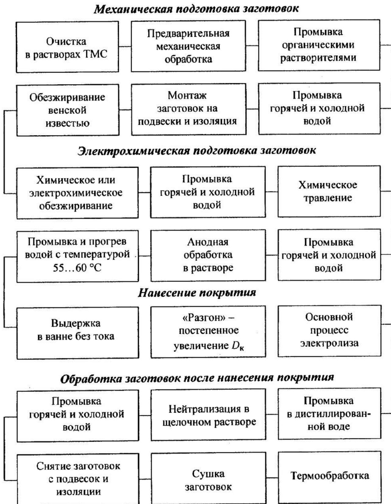
Рис. 51. Типовой процесс нанесения гальванических покрытий
