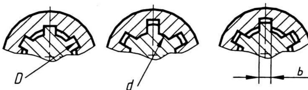
Рис. 36. Виды центрирования шлицевых соединений: а – по наружному диаметру D ; б – по внутреннему диаметру d ; в – по боковым поверхностям шлицев b
