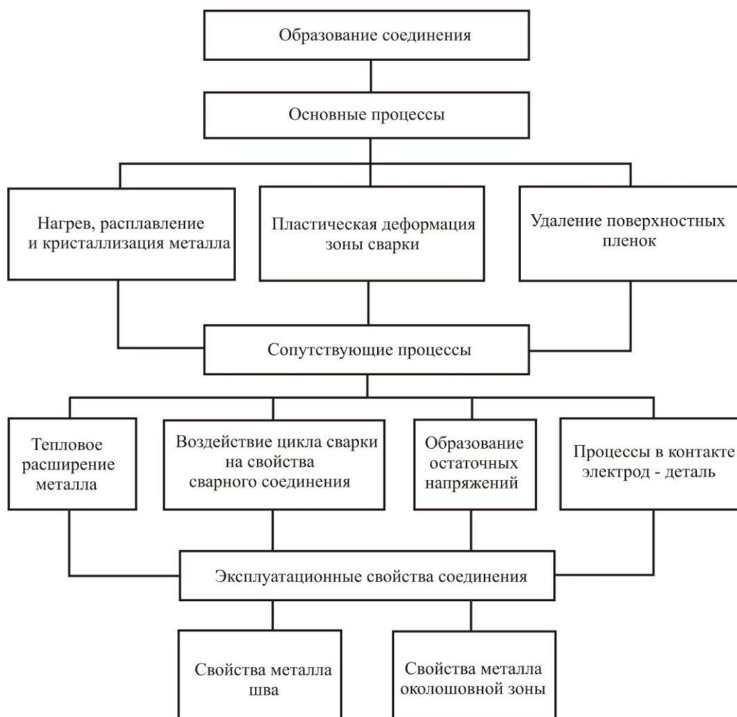
Рисунок 2 – Основные и сопутствующие процессы при образовании сварного соединения
