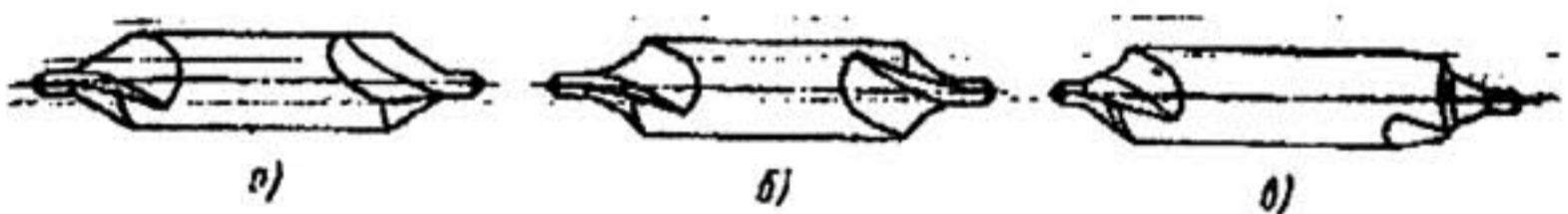
Рис. 3.14. Сверла для зацентровки под углом 60^\circ :
