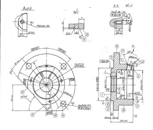
Рисунок 1.1 - Корпус подшипника
