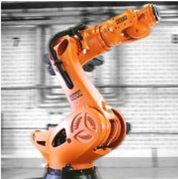
Рис. 1.7 Манипулятор промышленного робота KUKA без захвата (Германия)
