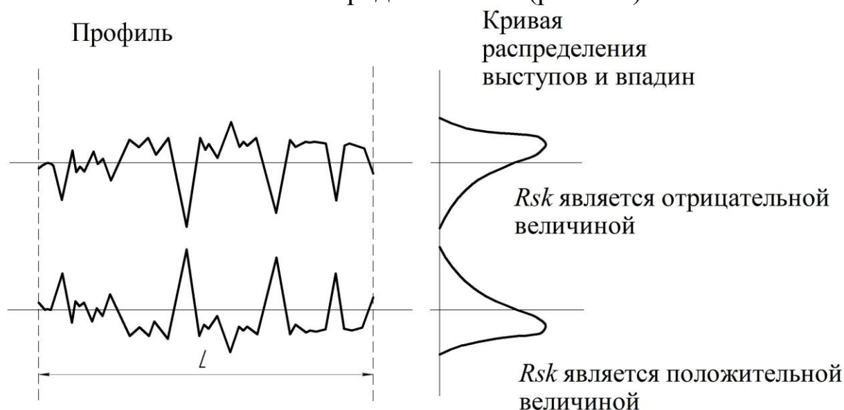
Рис. 6.8. Схема к определению высотных параметров шероховатости: справа – кривая распределения выступов и впадин
