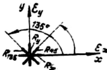
Рис. 5.10. Схема расположения тензорезисторов R_{x,y,45,135} для определения деформаций и напряжений
