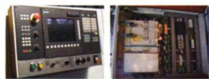
Система управления - SIEMENS SINUMERIK 802D, привода - цифровые SIMODRIVE 611UE. Электрооборудование SCHNEIDER. Пневматика KAMOZI, FESTO.
