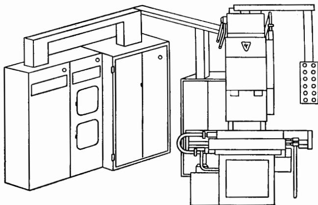
Станок с крестовым столом предназначен для одновременного фрезерования двух одинаковых деталей сложной формы торцовыми, концевыми, угловыми и фасонными фрезами.
