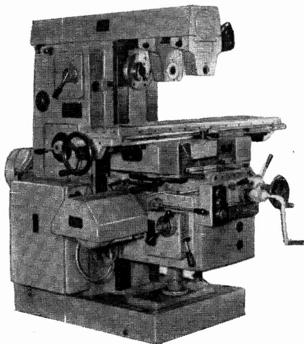
Стапок предназначен для обработки различных изделий из стали, чугуна, цветных металлов и пластмасс цилиндрическими, торцовыми, дисковыми, угловыми и специальными фрезами.
