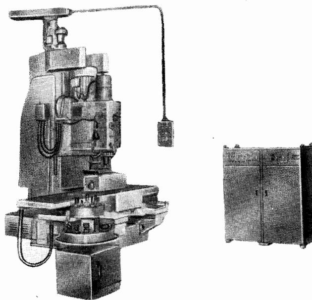
Станок предназначен для обработки сложных плоских и объемных поверхностей деталей по программе, записанной на перфоленте. На станке можно обрабатывать кулачки, копиры, штампы, пресс-формы.
