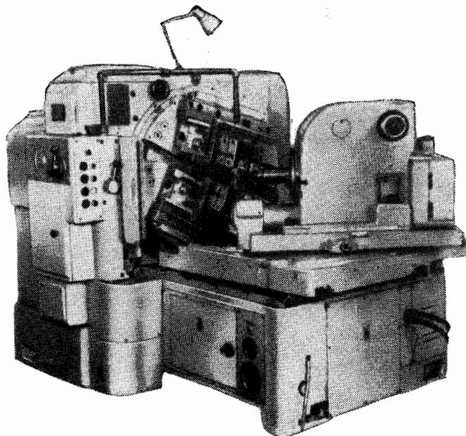
Станок предназначен для нарезания прямозубых конических колес. Он может применяться в различных производственных условиях, но особо пригоден для мелкосерийного и единичного производства, где главное значение имеют универсальность станка, простота и дешевизна режущего инструмента.
