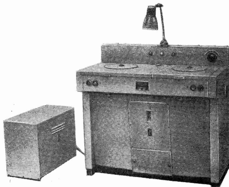
Станок модели 3881 предназначен для шлифования, а станок модели 3881Б — для полирования металлографических шлифов. Они применяются в лабораториях, занимающихся исследованием и анализом поверхностных и пограничных слоев материалов.
