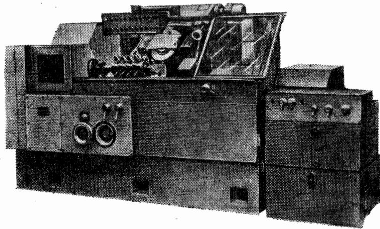
Станок предназначен для заточки и переточки прецизионных червячных фрез класса АА по нормали ОН431/5-62 и применяется на специализированных заводах с крупносерийным выпуском червячных фрез, а также на машиностроительных и металлообрабатывающих предприятиях, эксплуатирующих и изготавливающих червячные фрезы.
