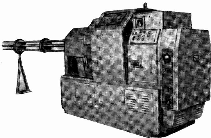
Автоматы модель 1216-6 нормальной точности и модель 1216-6К повышенной точности предназначены для обработки разнообразных деталей из калиброванного пруткового материала различного профиля и марок стали, алюминия и латуни.
