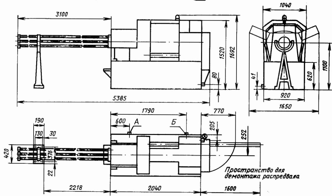
A -- отверстие  $\frac{3}{4}$ " для слива охлаждающей жидкости; B -- отверстие  $\frac{3}{4}$ " для слива масла
