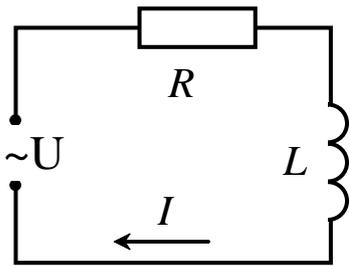
Рис. 2. Участок цепи, содержащий резистор и катушку индуктивности
