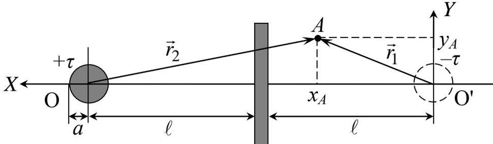
*Рис. 3. К расчету потенциала точки электростатического поля методом зеркальных изображений*
