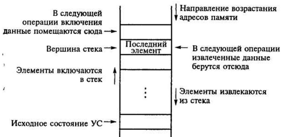
Рис. 4.10. Процессы записи данных в стек и извлечения из стека
