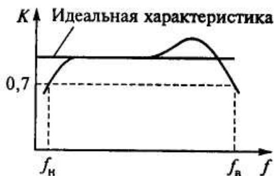
Рис. 2.2. Амплитудно-частотная характеристика усилителя
