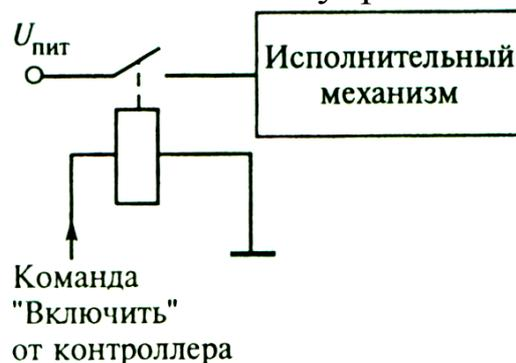
Рис. 2.39. Схема релейной развязки
