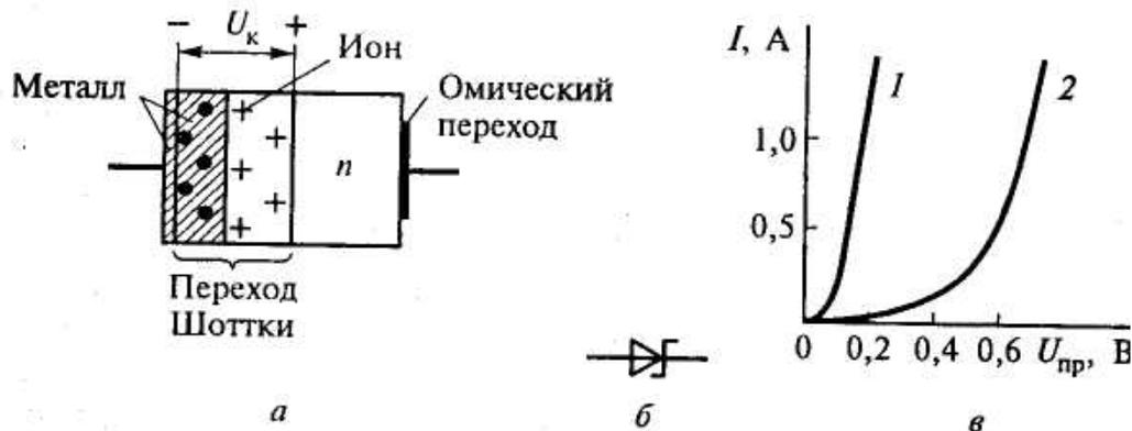
Рис. 1.5. Металлополупроводниковый диод Шоттки: а – структура диода; б – условное обозначение; в – вольт-амперная характеристика; 1 – переход Шоттки; 2 –  $p$ - $n$ -переход
