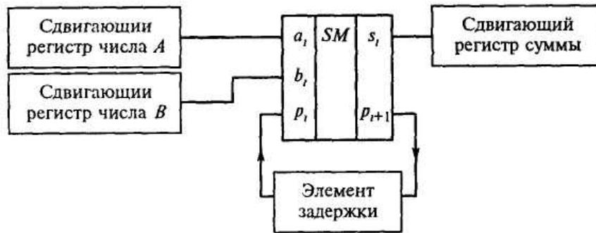
Рис. 3.14. Последовательный многоразрядный сумматор
