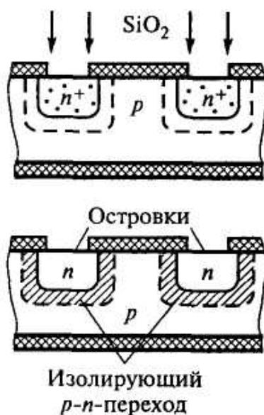
Рис. 1.19. Изготовление островков по планарно-диффузионной технологии
