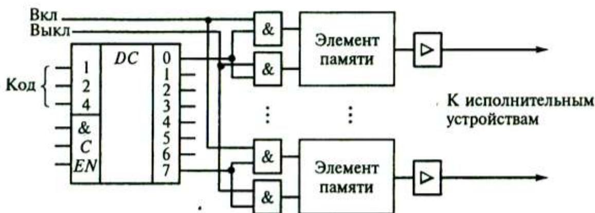
Рис. 3.6. Схема управления исполнительными устройствами технологической системы на основе дешифратора
