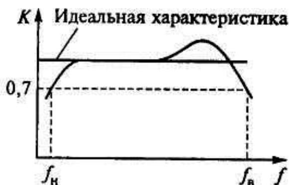
Рис. 2.2. Амплитудно-частотная характеристика усилителя
