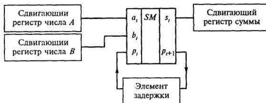
Рис. 3.14. Последовательный многоразрядный сумматор
