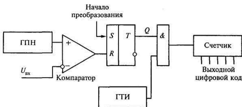
Рис. 2.24. АЦП, использующий способ пилообразного напряжения
