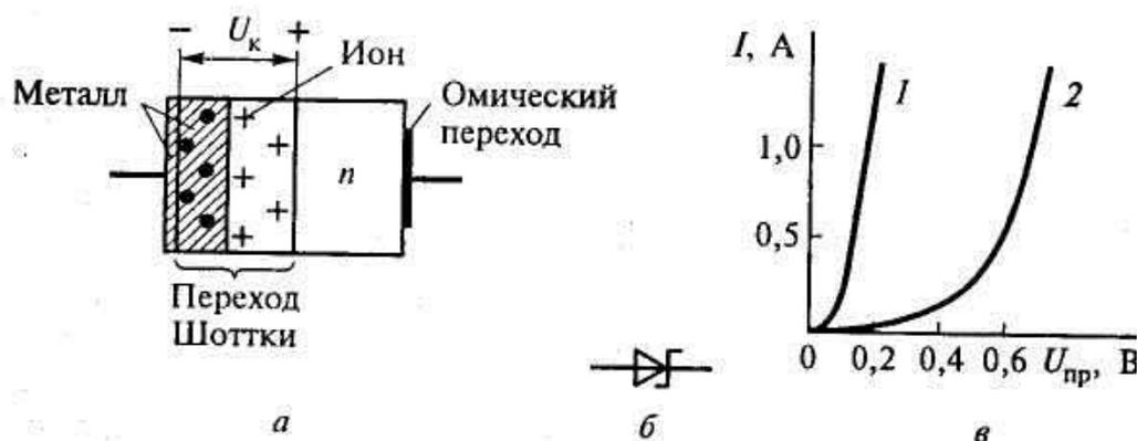
Рис. 1.5. Металлополупроводниковый диод Шоттки:
