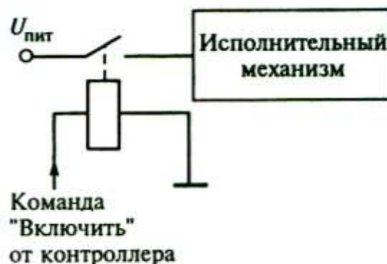
Рис. 2.39. Схема релейной развязки
