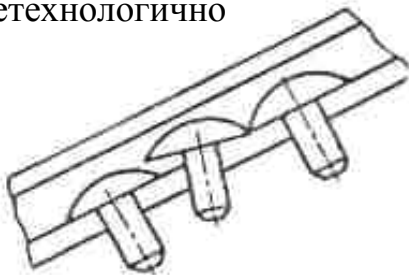
Рис. 108. Способы улучшения технологичности деталей для избежания заклинивания в направляющих
