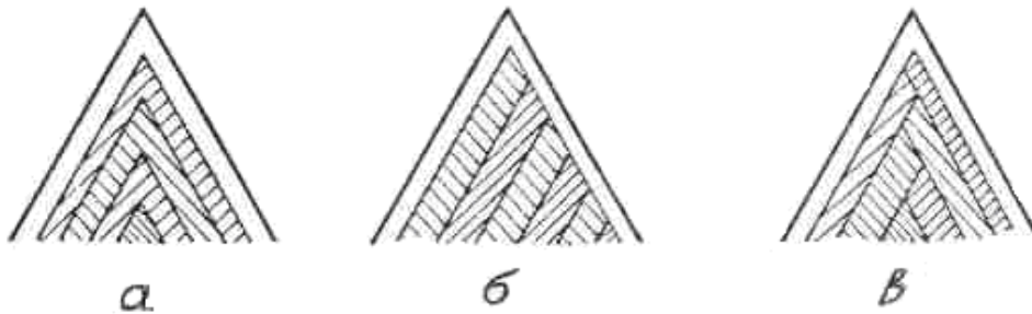
Рис. 56. Схемы обработки профиля крепежной резьбы (обозначения в тексте)
