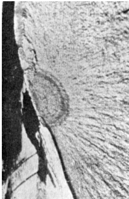
Рис. 3.8. Линии остановки фронта трещины на детали из стали 09Г2С, вызванные коррозией под напряжением. Эти линии обусловлены различной скоростью коррозии на поверхности трещины. Они не должны быть отнесены к линиям усталости, \times 4
