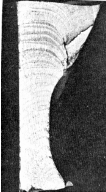
Рис. 3.7. Линии усталости на усталостном изломе поковки из алюминиевого сплава 7075-T73. Светлые, отражающие свет полосы – зоны медленного распространения трещины. При больших увеличениях внутри каждой полосы могут быть выявлены тысячи усталостных бороздок. Тусклые волокнистые полосы представляют собой зоны распространения трещины, образовавшиеся путем слияния микропор
