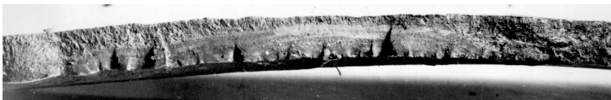
Рис. 3.13. Поверхность излома сварного шва: a – «шевронный узор», ориентированный к очагу разрушения; б – зона долома в металле шва; в – старая трещина и фронт развития разрушения
