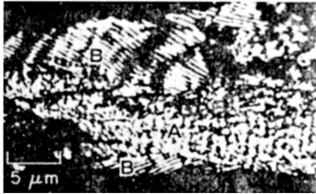
Рис. 3.9. Хрупкие (А) и вязкие (В) бороздки в изломе образца из высокопрочного алюминиевого сплава 7178-Т6. Хрупкие бороздки всегда лидируют, а вязкие бороздки тянутся вслед, как в кильватере корабля, \times 2000
