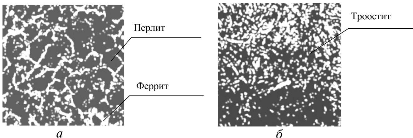
Рис. 7. Структура полутеплостойких штамповых сталей горячего деформирования (типа 5ХНМ)
