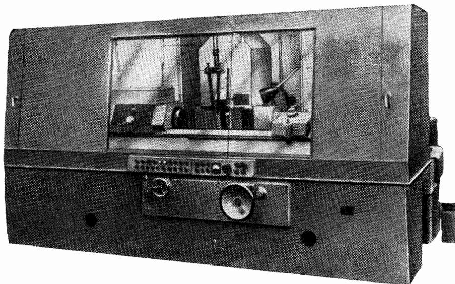
Станок предназначен для выполнения основных резьбошлифовальных операций в инструментальных и механических цехах машиностроительных заводов.
