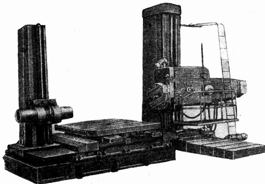
Станок предназначен для индивидуальной или серийной обработки тяжелых корпусных деталей больших габаритов, имеющих точные отверстия, связанные между собой точными расстояниями.
