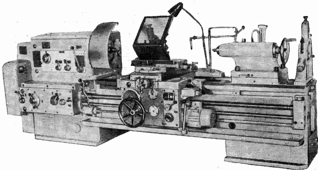
Станок предназначен для выполнения разнообразных токарных и винторезных работ, включая точение конусов и нарезание резьб (метрической, модульной, дюймовой и питчевой). На станке можно обрабатывать изделия из черных и цветных металлов.
