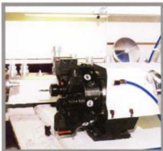
Предназначен для патронной и центровой обработки с высокой точностью малогабаритных деталей с большим количеством проходов и сложного профиля из различных конструкционных сталей и сплавов.
