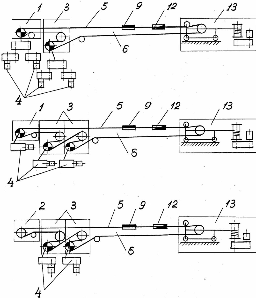
Рис. 4. Компонировочные схемы ленточных конвейеров с шириной ленты 1200, 1400, 1600 мм, выпускаемых АО "Тяжмаш" г. Сызрани
