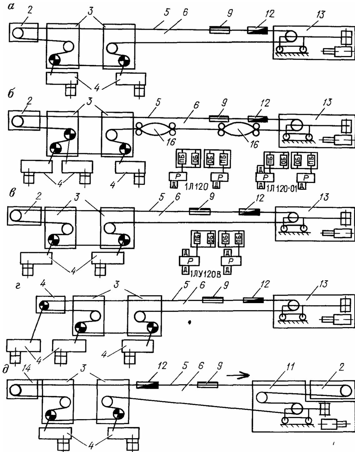
Рис. 3. Компонентные схемы унифицированных ленточных конвейеров с шириной ленты 1200 мм:
