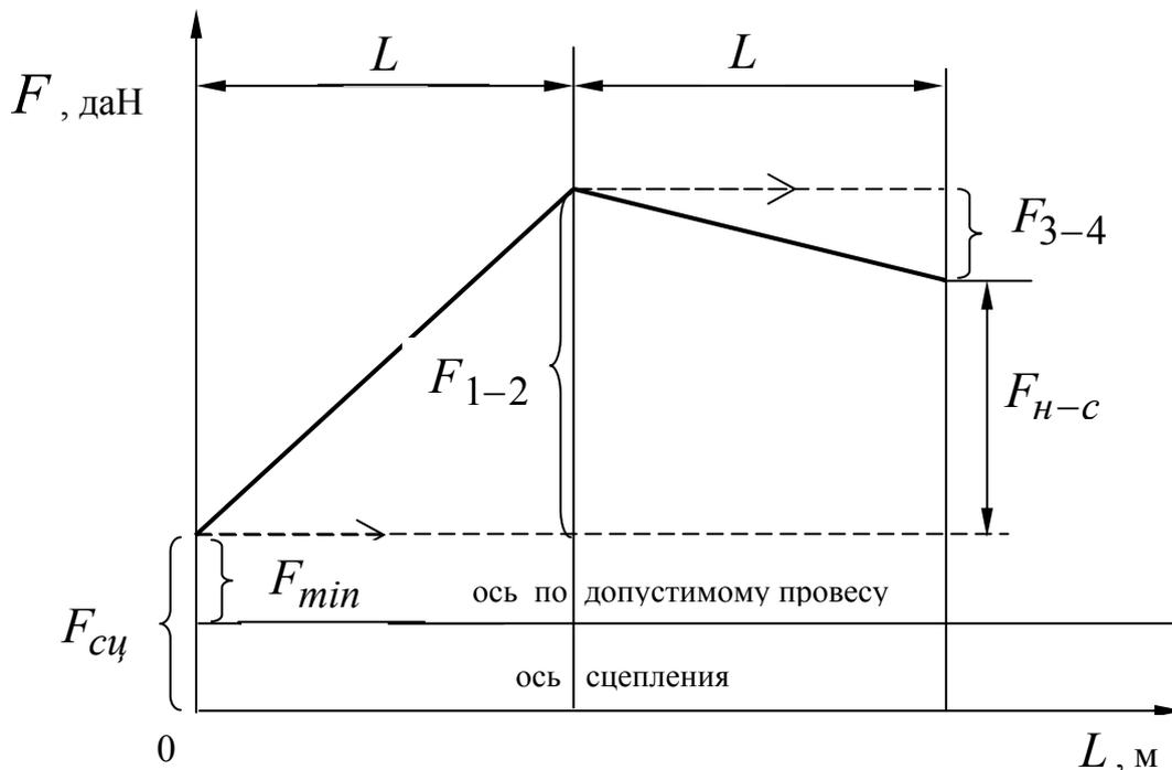
Рис. 2. Построение диаграммы натяжения ленты ленточного конвейера
