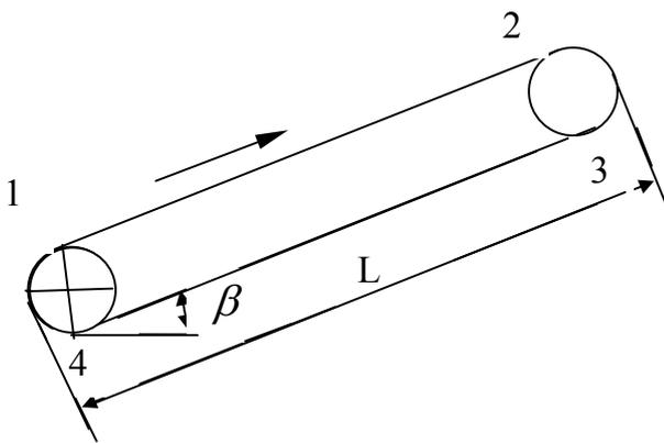
Рис. 1. Упрощенная расчетная схема конвейера
