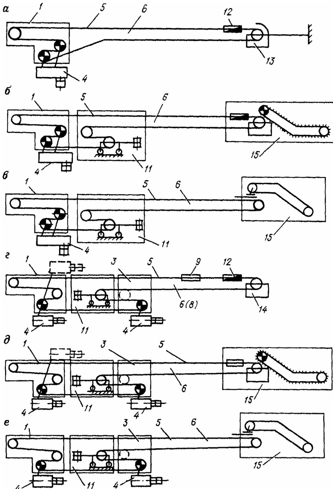
Рис. 1. Компонировочные схемы унифицированных ленточных конвейеров с шириной ленты 800 мм:
