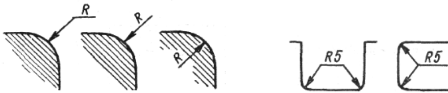
Рисунок 6 – пример обозначения радиусов на чертежах
