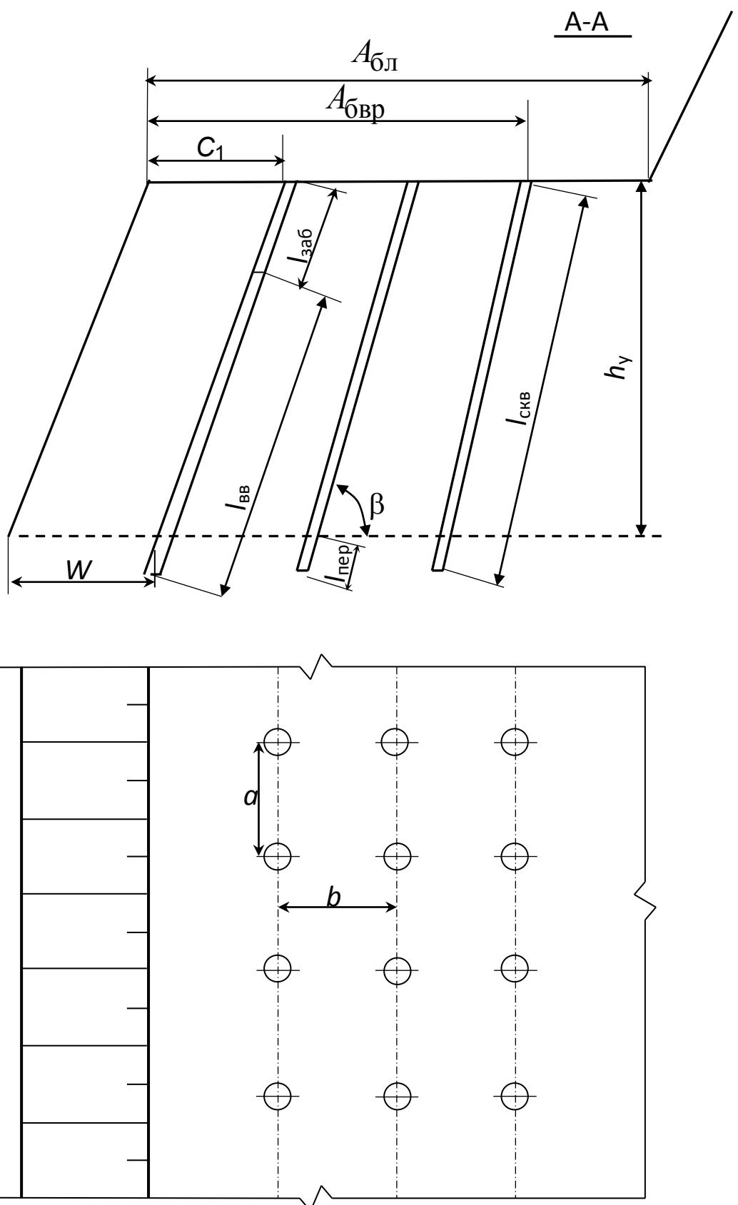
*Рис. 3. Схема пространственного расположения наклонных скважин по прямоугольной сетке*
