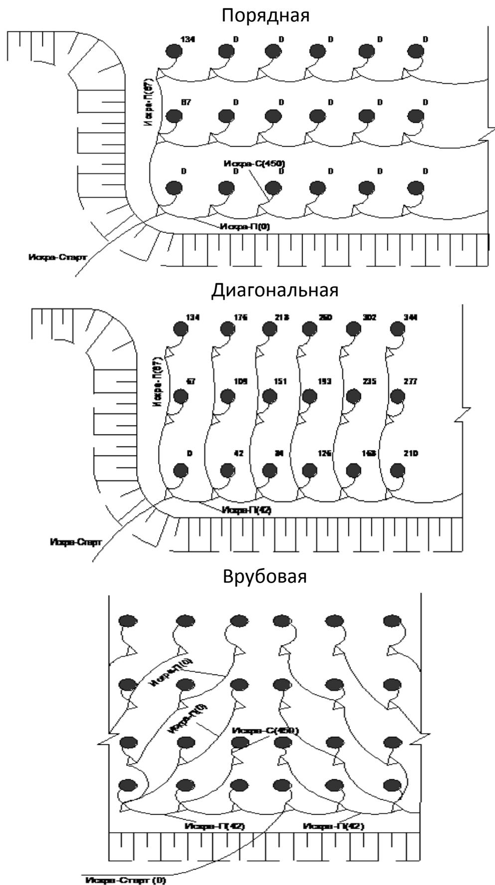
Рис. 6. Схемы инициирования зарядов с применением УВТ
