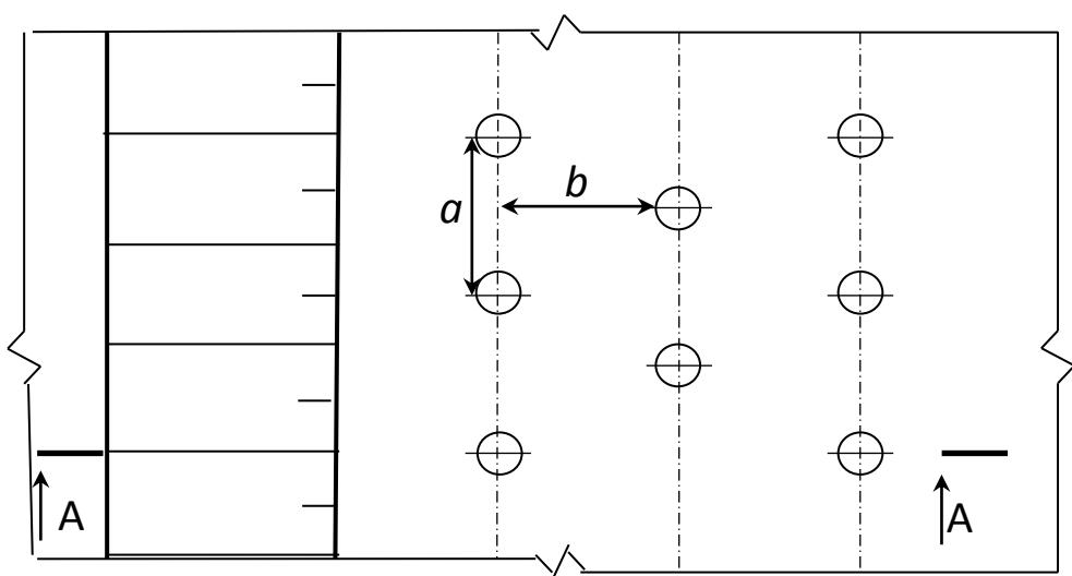
*Рис. 2. Схема пространственного расположения вертикальных скважин по шахматной сетке*
