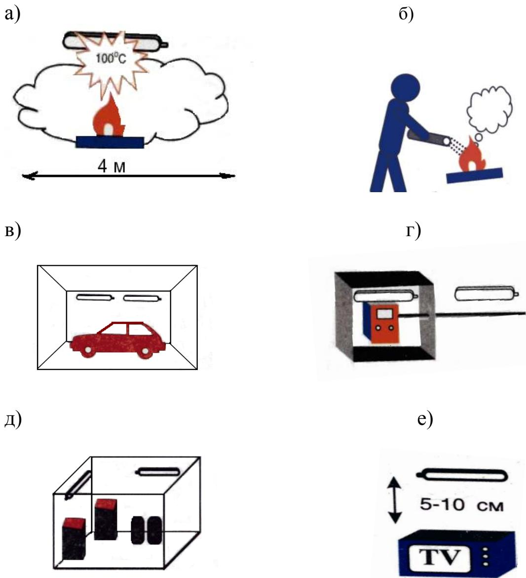
Рис. 10. Использование огнетушителя ОСП:
