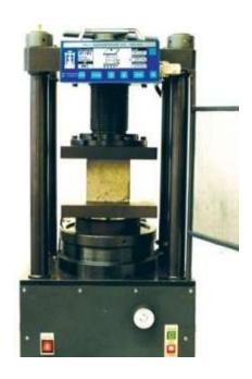
Рисунок 4 – Пресс испытательный гидравлический ПГМ МГ4
