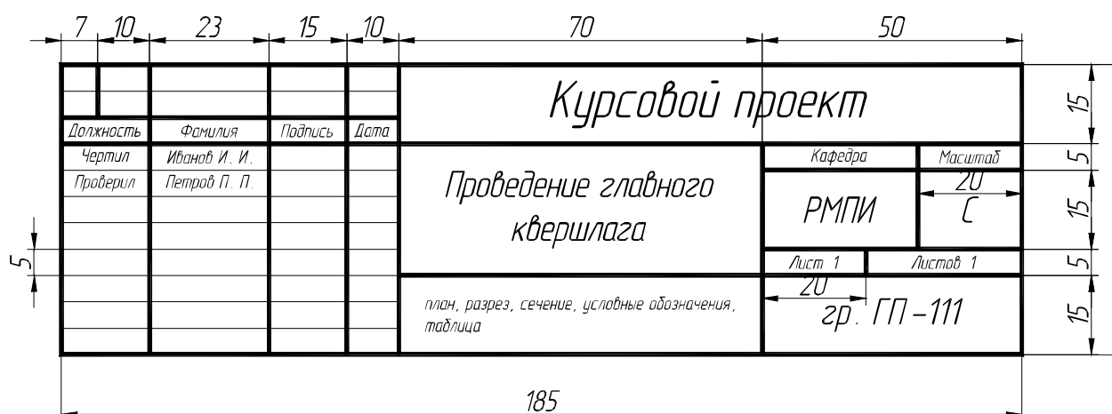
Рис. 17. Размеры основной надписи чертежа
