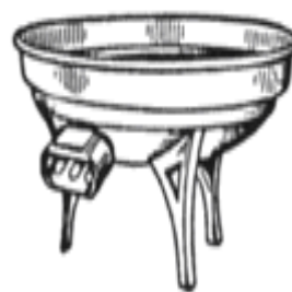
Рис. 30. Мешалка магнитная: 1 – стакан с жидкостью; 2 – «мешальник»; 3 – корпус
