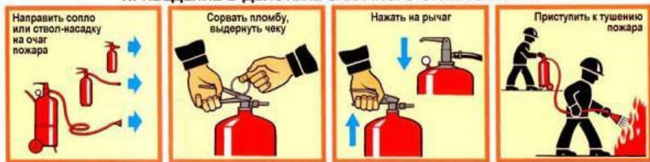
Рисунок 4.1 – Принцип действия закачного порошкового огнетушителя
