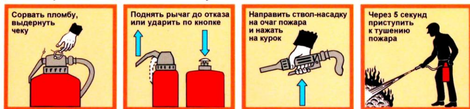
Рисунок 4.2 – Принцип действия огнетушителя со встроенным источником давления
