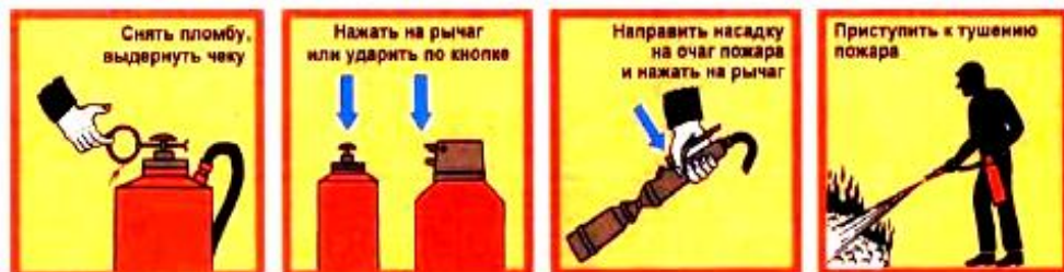
Рисунок 4.6 – Принцип действия воздушно-пенного огнетушителя типа ОВП
