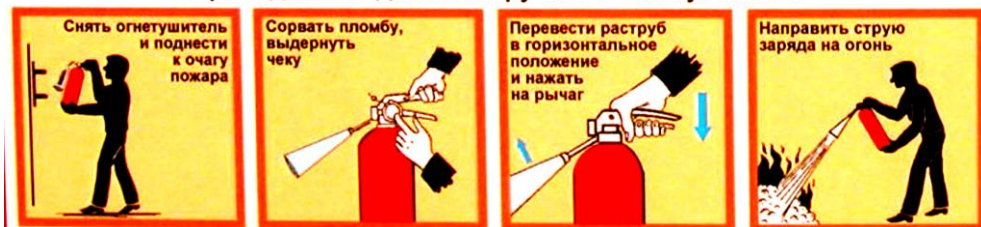
Рисунок 4.8 – Принцип действия углекислотного огнетушителя ручного типа
