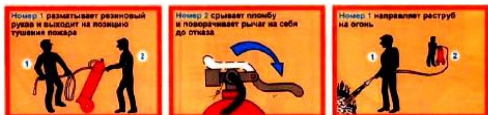
Рисунок 4.11 – Принцип действия углекислотного огнетушителя передвижного типа
