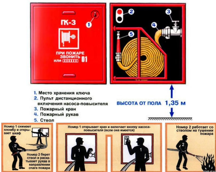
Рисунок 3.3 – Внутренний пожарный кран и действия при пожаре
