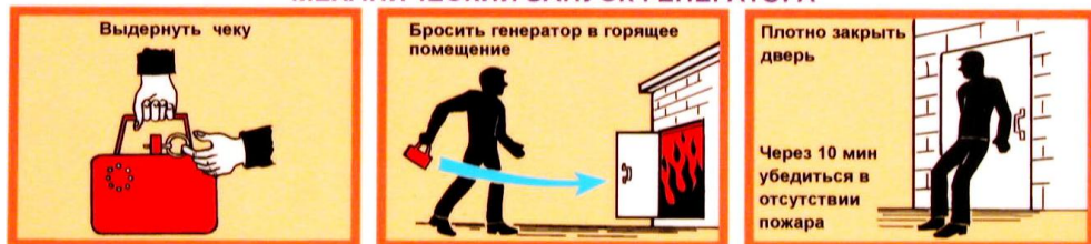
Рисунок 4.19 – Принцип действия аэрозольных генераторов ручного действия
