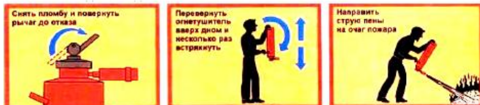
Рисунок 4.5 – Принцип действия химического пенного огнетушителя типа ОХП
