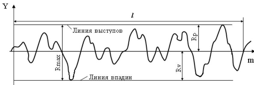
Рисунок 2 – Наибольшая высота неровностей профиля R_{\max} .
