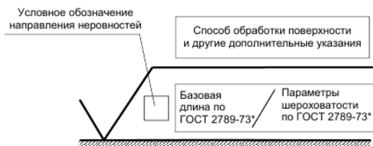
Рисунок 6 – Структура обозначения шероховатости на чертежах.
