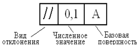
Рисунок 1 – Рамка для обозначения допусков формы и расположения.
