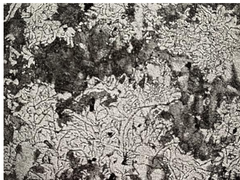
Рисунок 3. Влияние кремния на микроструктуру чугуна: а – Si = 0,97%; б – Si = 1,21 %
