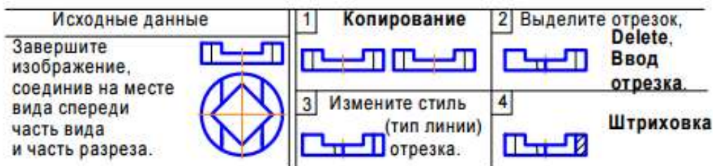
Рис. 1.5. Соединение части вида и части разреза
