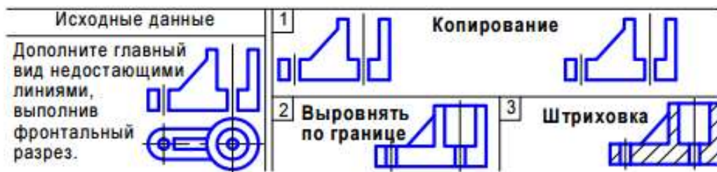
Рис. 1.6. Разрез детали с ребром жесткости
