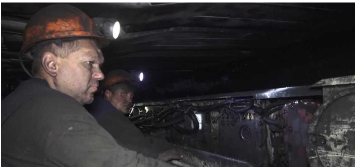
Рисунок 1. Непосредственное управление выемочным комбайном в лаве
