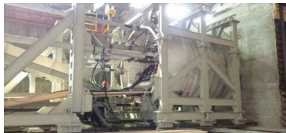
Рисунок 1. Опытный образец геохода модели «401» диаметром 3,2м: а) в цеху завода ОАО «КОРМЗ», б) на испытательном стенде
