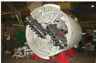
Рисунок 1. Опытный образец геохода модели «401» диаметром 3,2м: а) в цеху завода ОАО «КОРМЗ», б) на испытательном стенде
