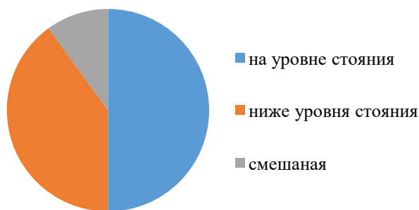
Рисунок 3. Долевое соотношение уровней установки автосамосвалов под погрузку горной массы драглайнами
