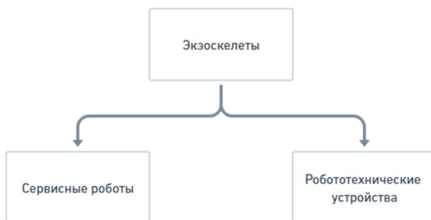
Рисунок 1. Классификация экзоскелетов по наличию исполнительных приводов
