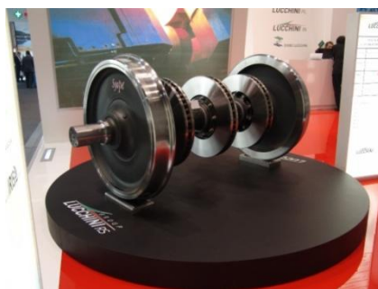
Рисунок 4. Осевой тормозной диск на необмотрленной колесной паре высокоскоростного подвижного состава
