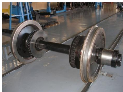
Рисунок 3. Осевые тормозные диски необмотрленной колесной пары пассажирского вагона
