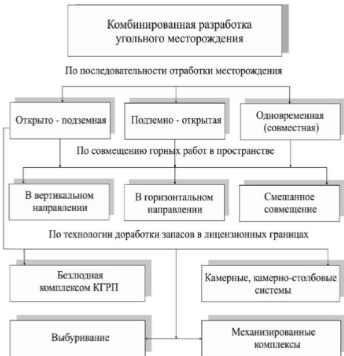
Рисунок 1. Классификация комбинированного способа разработки угольных месторождений
